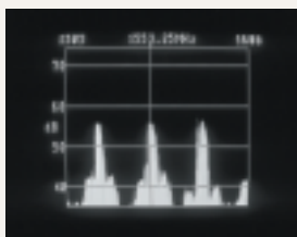
Darstellung eines SAT-Spektrums im Schmalbandbetrieb. Hier werden Kreuzpolarisationen sichtbar.
